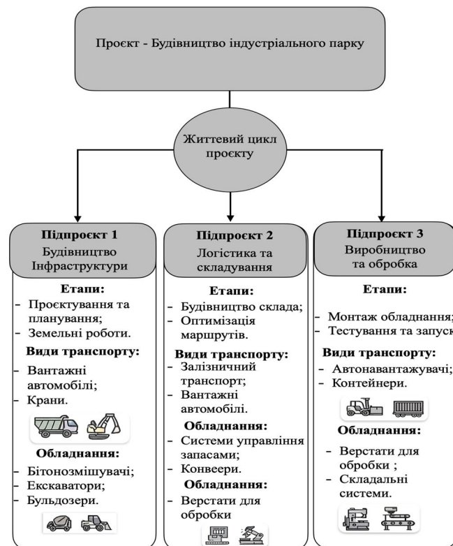
Рис. 8. Схема взаємозв'язку життєвого циклу проєкту будівництва індустріального парку з життєвими циклами його підпроєктів
